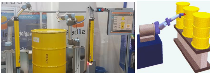
Figure 1: Système de caractérisation de colis de déchets
